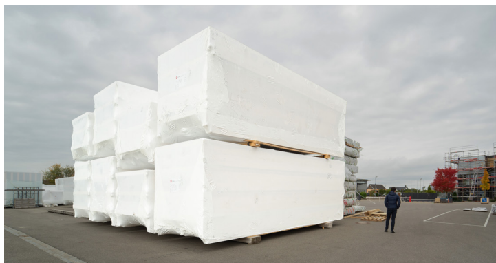
Abbildung 12: Lagerung folierter Bauteile auf dem Werksgelände
