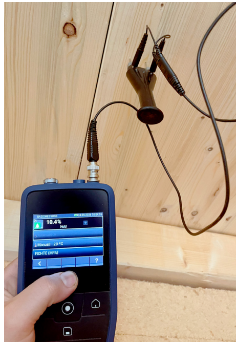
Abbildung 18: Holzfeuchtemessung mittels elektrischer Widerstandsmessung
