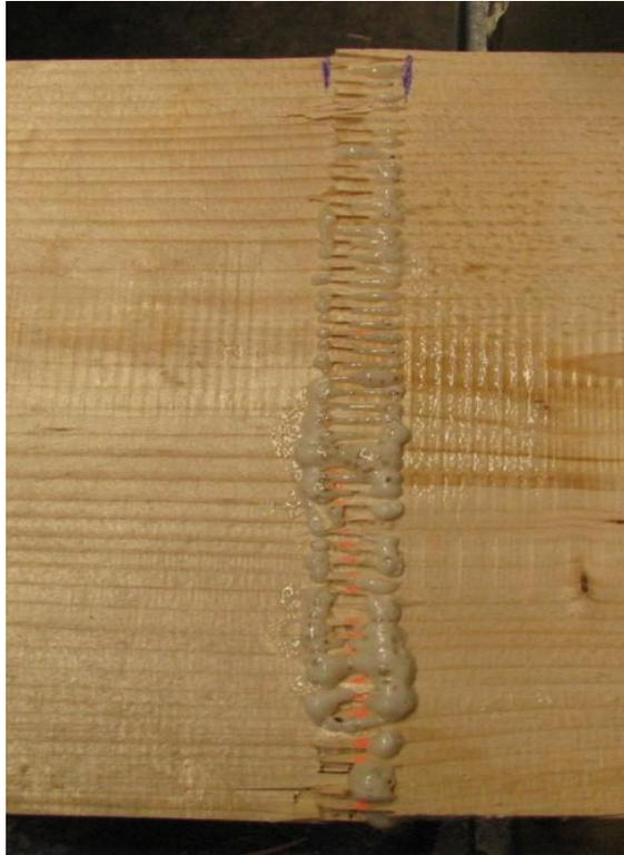
**Abb. C.2** Verpresste Keilzinkung mit austretendem PU (Bildquelle HFA, Wien)
