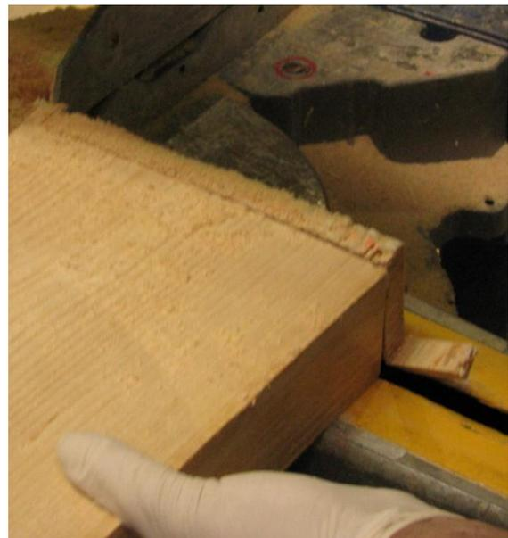
**Abb. C.5** Trennschnitt im zweiten Zinkengrund (Bildquelle HFA, Wien)
